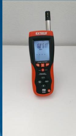
**Psicrometro Extech HD500** per calcolo umidità percentuale, umidità relativa, punto di rugiada (zone di possibile formazione di muffe)
